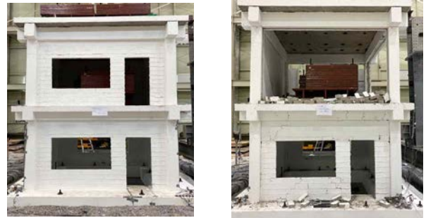
a) 정면 파괴전 b) 정면 파괴후 그림4. 전후 파괴 형상
